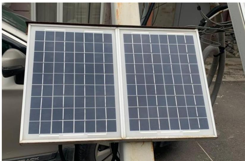
Рисунок 3 – Поликристаллические панели использованный для эксперимента
